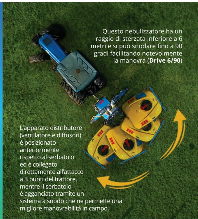
Questo nebulizzatore ha un raggio di sterzata inferiore a 6 metri e si può snodare fino a 90 gradi facilitando notevolmente la manovra (Drive 6/90)
