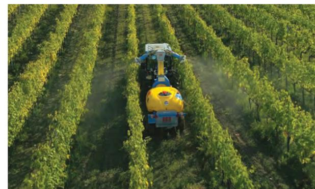
La versione "**CALIFORNIA-VIGNETO**" è idonea per trattamenti di vigneti a filari alterni, ovvero 4 pareti con enorme risparmio di tempo perché vengono ridotti esattamente della metà i passaggi mantenendo una struttura leggera, agile ed affidabile della macchina.
