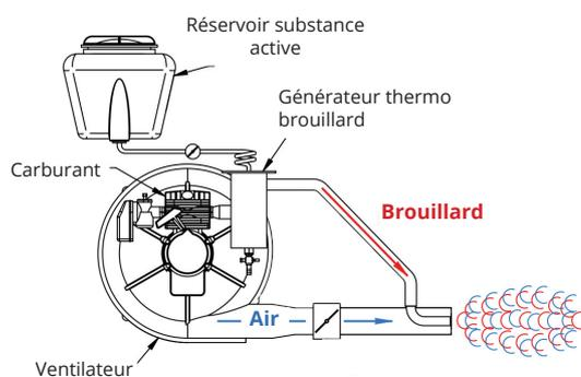
Le système breveté pour la production de brouillards thermiques fonctionne utilisant l'action fluïdo-dynamique des ventilateurs à haut rendement des Nébuliseurs Martignani.
