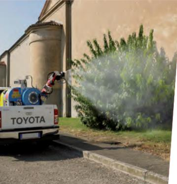
La **micronisation** parfaite et **uniforme** obtenue avec un type unique de buse pneumatique, à passage large (4 mm), avec une **fonctionnalité constante, sans aucun problème d'usure** et blocage, ni d'entretien.
