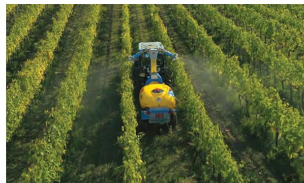
La version "**CALIFORNIA-VIGNE**" est adaptée au traitement des vignobles avec des rangées de vignes alternées, c'est-à-dire 4 parois avec un énorme gain de temps car le nombre de passages est réduit exactement de moitié tout en maintenant une structure légère, agile et fiable de la machine. L'inclinaison des deux têtes supérieures est réglable à l'aide d'une option hydraulique depuis le siège du conducteur, ce qui est idéal pour les opérations en pente.
